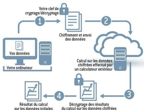
Figure 1. Schéma de calcul reposant sur le principe du chiffrement homomorphe (pour la Science n°456, octobre 2015).
